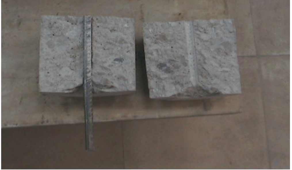
Fotoğraf 3.1 Beton Numunenin Çekme Bölgesinde Ezilmesi
