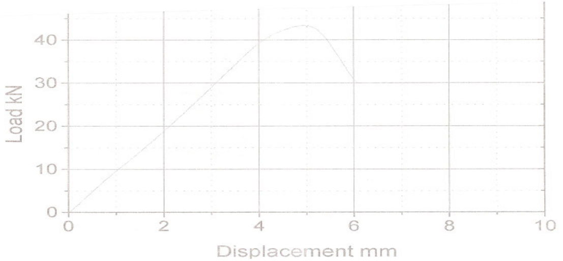
Şekil 2.15 Çelik Çubuğun Sıyrıldığı Andaki Yük Değeri ve Yük-Uzama Grafiği
